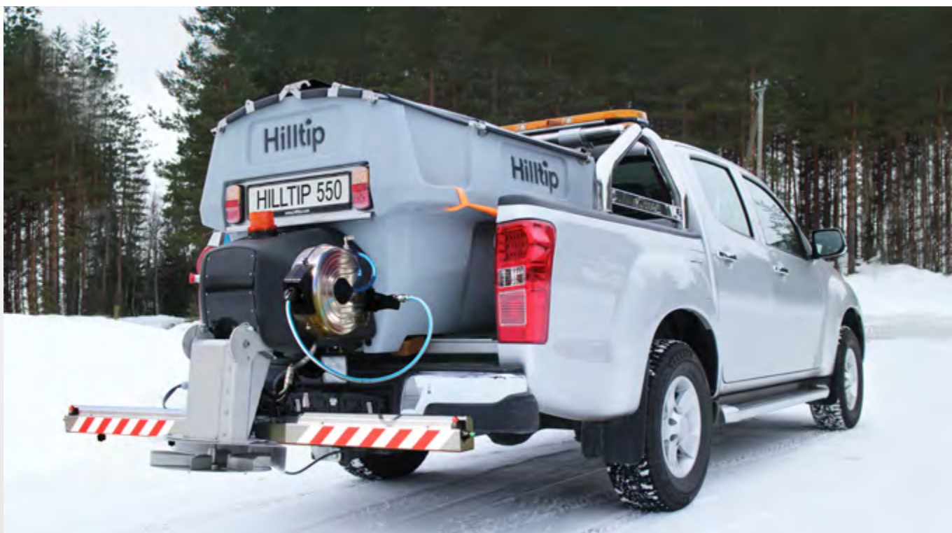
Rozmetadlo 550 I v plné výbavě s předvlhčovacím systémem, bubnem s 12m hadicí a postřikovací lištou
